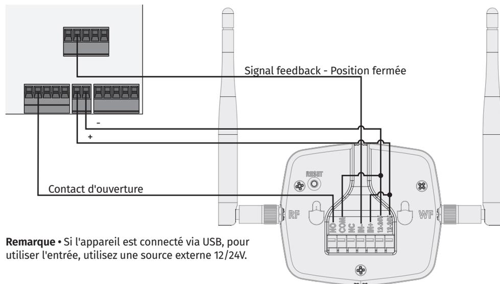
**Remarque** • Si l'appareil est connecté via USB, pour utiliser l'entrée, utilisez une source externe 12/24V.
