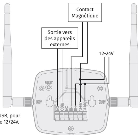
**Remarque** • Si l'appareil est connecté via USB, pour utiliser l'entrée, utilisez une source externe 12/24V.
